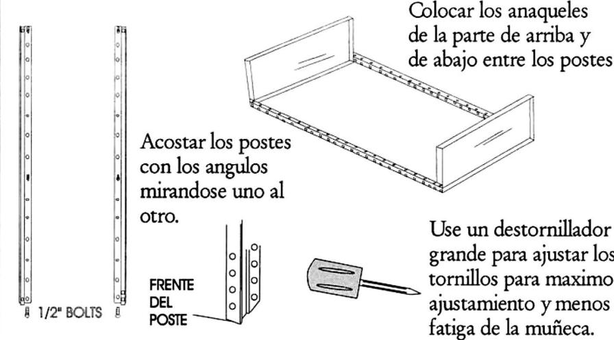
Inserte el tornillo shoulder a través del agujero del poste y el agujero del anaquel. Conecte la tuerca de seguridad en sus 4 puntos y apretar los tornillos shoulder.
