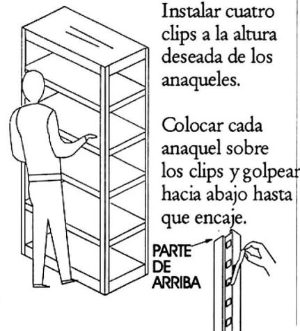
Instalar cuatro clips a la altura deseada de los anaqueles.
